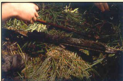
Ermittlung der Untergrundbeschaffenheit mittels Klappsonde
